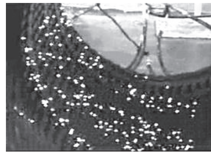
写真1 電動機固定子巻線の放電 Photo 1 Discharge at stator coil of motor
